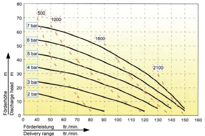
Um eine optimale Lebensdauer zu erzielen, sollen die Betriebsparameter der Pumpen für den Normalbetrieb etwa in der Mitte des Leistungsdiagrammes liegen.
