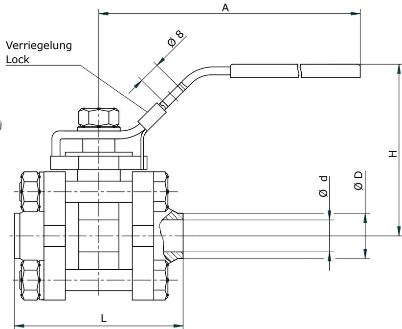
Die Kugelhähne (Mittelteil) Typ 8001.1 - 8007.1 sind radial ein- und ausbaubar.
